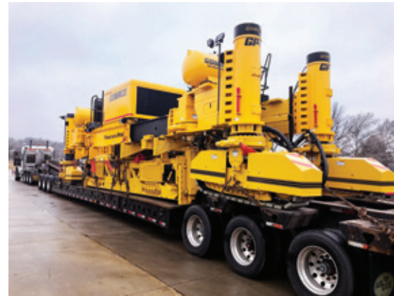
A pavimentadora de concreto GP4 da GOMACO tem a capacidade de aplicar até 12,2 metros de largura.
