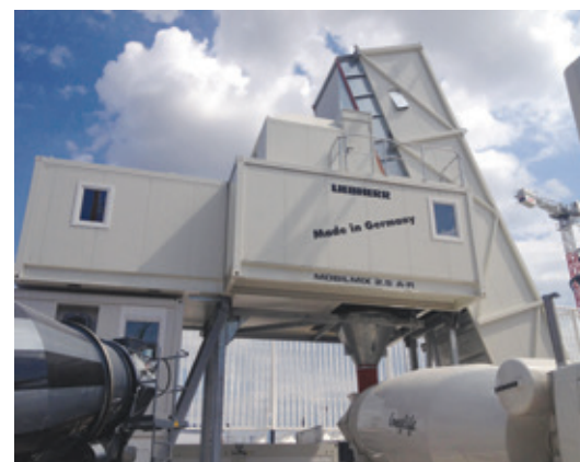
Aqui a nova central misturadora da Liebherr, a Mobilmix 2.5, que tem alta capacidade sem deixar de ser modular e móvel.
