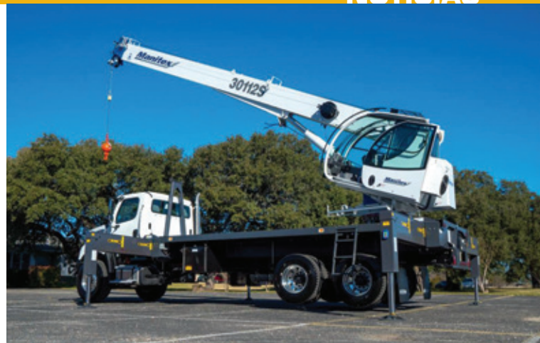
O TC30112 incorpora uma nova cabine com a capacidade de se inclinar em 20° para maior conforto do operador.
