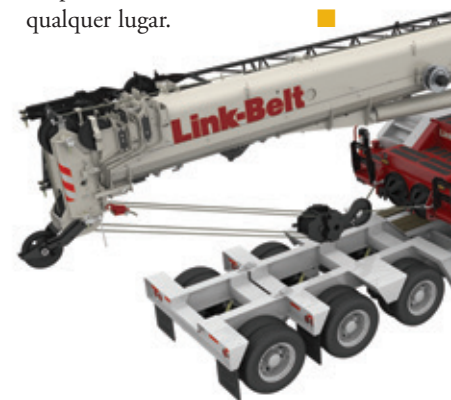
O guindaste tem capacidade máxima de 20 toneladas e capacidade de ponta de lança de 2,5 toneladas.
