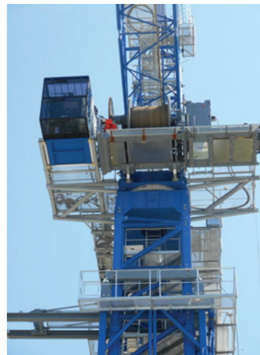
A nova cabine de arestas retas montada num guindaste basculante na fábrica da Linden Comansa, em Pamplona, Espanha.
