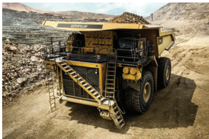
O Cat 794 AC, que tem capacidade de 320 toneladas e potência de 3.500 HP.
