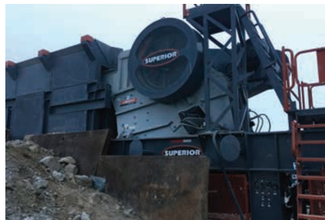
El triturador de mandíbula Liberty Jaw Crusher funciona como un triturador primario.
