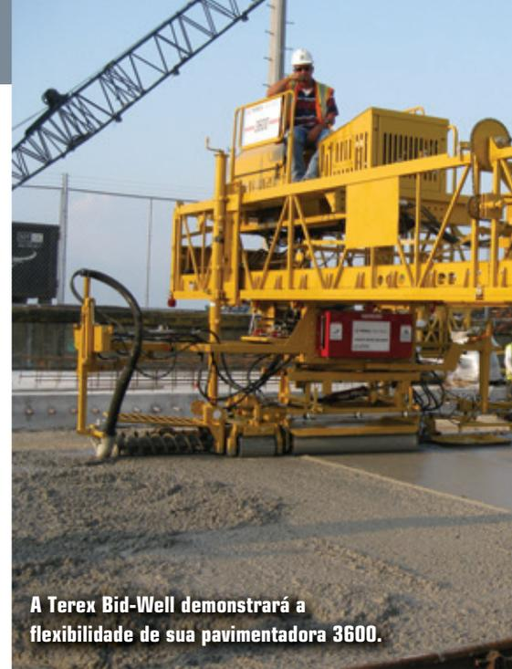
**A Terex Bid-Well demonstrará a flexibilidade de sua pavimentadora 3600.**
