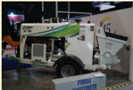
A Schwing marcou presença através de seu distribuidor Emarea, com uma bomba estacionária SP 500.
