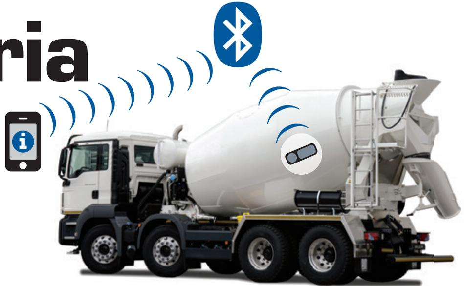
**Uma melhora que já se começa a perceber na indústria é a instalação de sensores que permitem medir as propriedades do concreto dentro da betoneira.**
