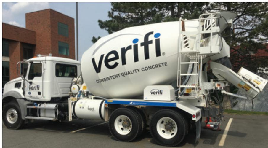
**O sistema compensa o slump durante o transporte através de medições precisas.**
