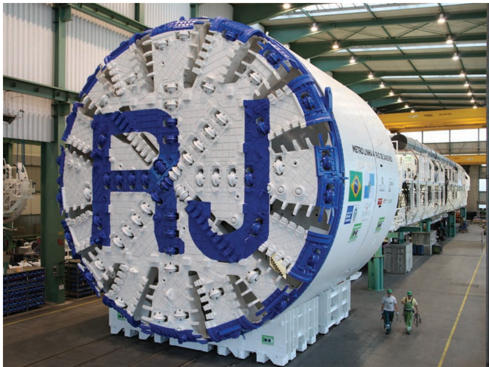
O equipamento EPB da Herrenknecht, de 11,46 metros de diâmetro, escavará um túnel de 4,6 quilômetros.
