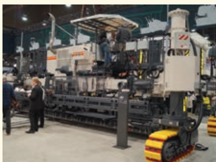
A Wirtgen expôs sua pavimentadora SP 94i, que cumpre com o padrão Tier4 Final.
