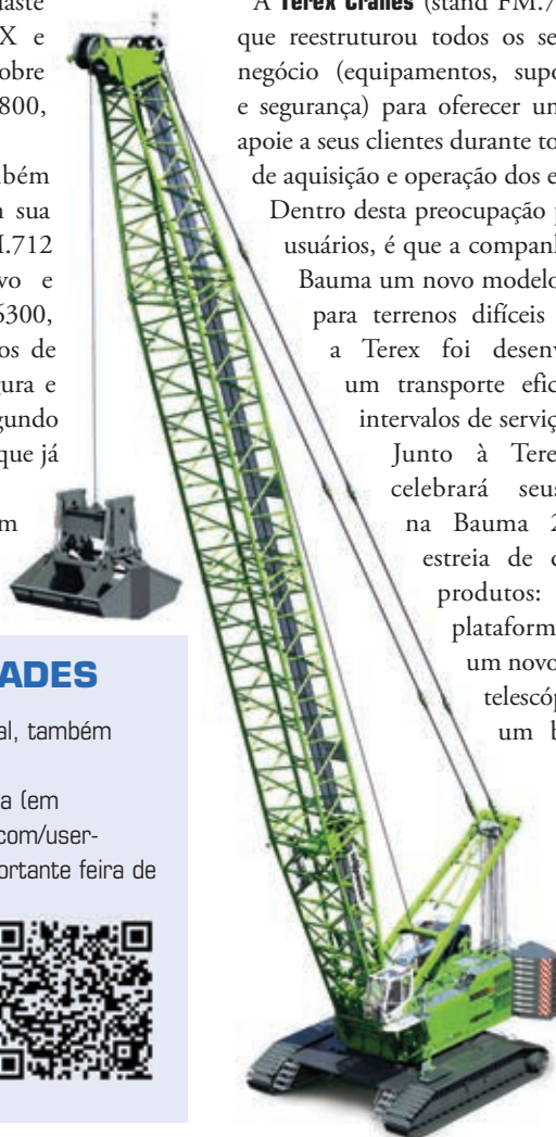
A Sennebogen 6300 tem 12 metros de altura, 6,8 metros de largura e 300 toneladas de peso.
