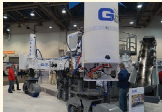
A nova pavimentadora multiuso da G&Z, a S400, tem uma capacidade de operação entre 2 e 7,5 metros de largura.
