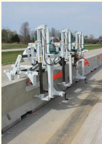
⬆ O novo equipamento da Minnich permite uma rápida e eficiente perfuração fixação de barreiras de concreto.
