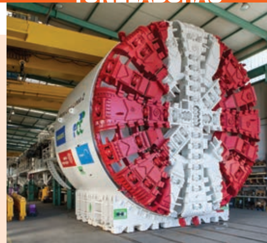
Para a construção do metrô de Lima, se utilizam duas tuneladoras de 10,19 metros de diâmetro. Na foto, a EPB Shield S-972.
