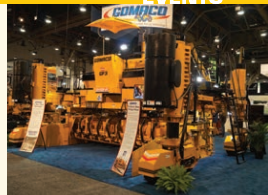
⬆ A GOMACO GP 3 foi projetada para variar a largura da pavimentação.
