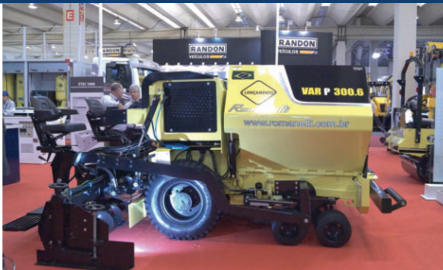
ACIMA: Adequada para obras pequenas e médias, as vibroacabadoras Romanelli Var P300.6 têm nova tecnologia eletrônica e sistema de joystick de alta resistência e baixa demanda de manutenção.
