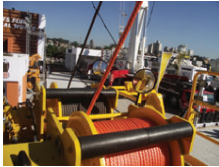
A Manitowoc apresentou o novo KZ100, o primeiro cabo de elevação sintético especificamente projetado para guindastes.
