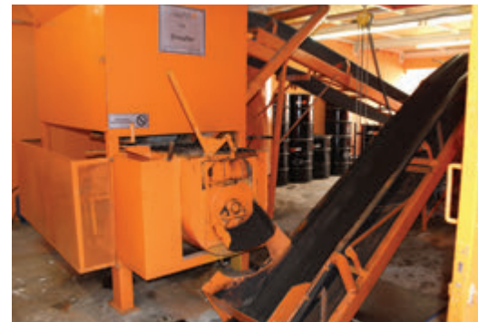
Para viabilizar o modelo, a Único produz sua própria usina de asfalto. Este é o modelo Boxster, com capacidade de 5 toneladas hora.
