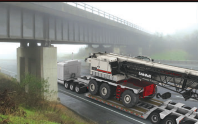
Transporte de alturas menores que 4,45 m no reboque e menores que 3 m de largura COM pneus e lança.
