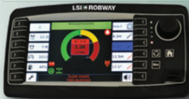
RCI-8510 Visor Multi-Sensor & Controlador de Guindaste
