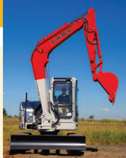
A 80SA é uma escavadeira compacta que permite escavação lateral sem giro da mesa.
