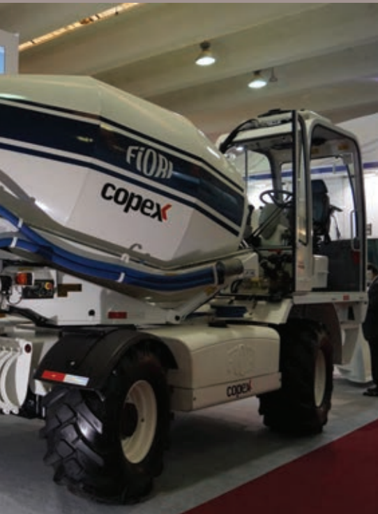
A autoconcreteira Fiori DB 260 oferece os avanços da tecnologia CBV e giro de tambor de 360°.
