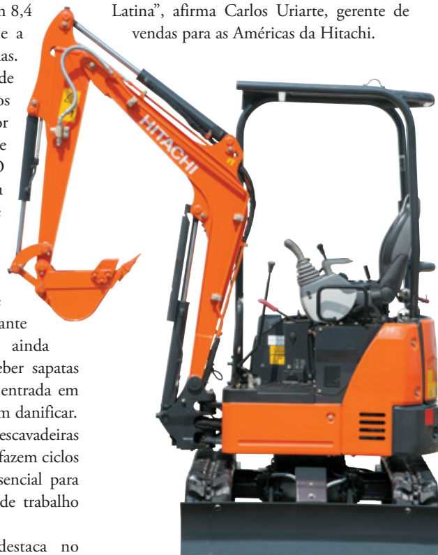
A japonesa Hitachi aposta no que chama “zero tail swing” para permitir um giro sem obstáculos de sua ZX19-5.
