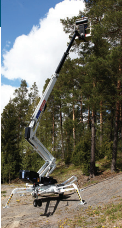
A Dinolift tem lanças sobre reboques com alturas de trabalho entre 10 e 26 metros.
