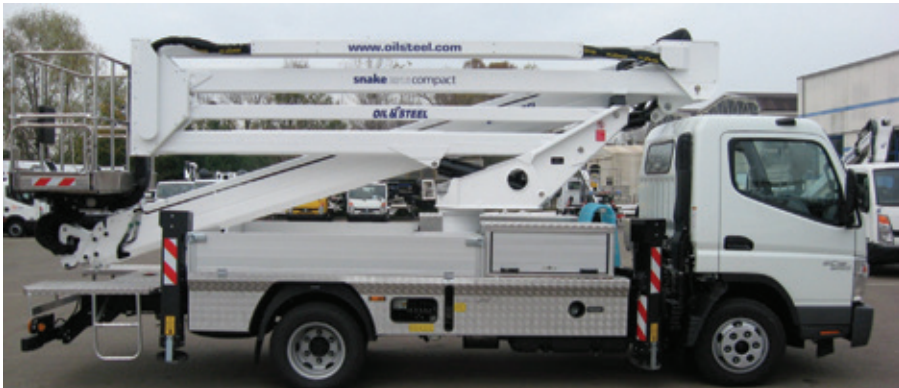
A Snake 2815 Compact é uma plataforma articulada para veículos com capacidade nominal de carga de ao menos 6 toneladas.
