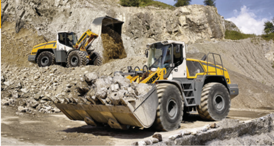
A carregadeira sobre rodas L 550 da Liebherr tem transmissão hidrostática motorizada a diesel com 147 kW de potência, e cumprindo as normas Stage II / Tier 2 e GOU III.
